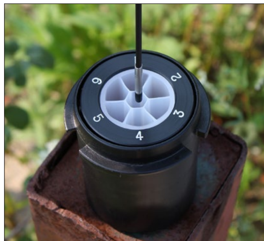
Mediciones hechas a través de los canales angostos del sistema Multicanal CMT de Solinst.
